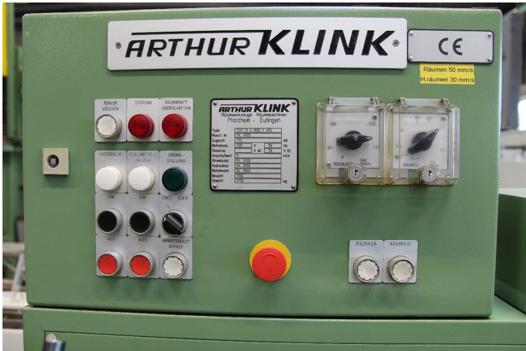
Bedienpanel mit Hub & Rückhub- Geschwindigkeitsverstellung
